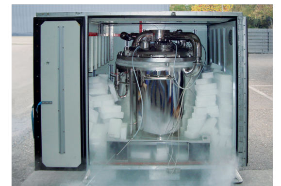
Edelstahlbehälter transportbereit für den Lufttransport im LD3-Container, mit Trockeneis gekühlt
